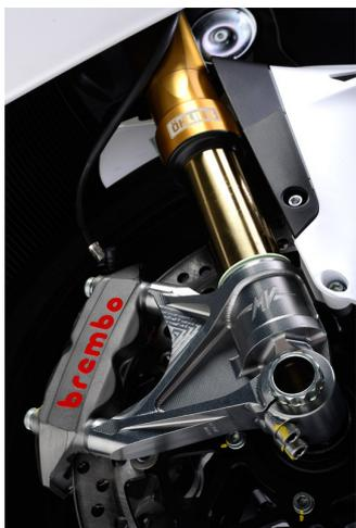
La horquilla invertida Öhlins NIX monta barras de 43mm con tratamiento antifricción de nitruro de titanio, todo ello para mejorar la precisión de funcionamiento. La particular medida de esta horquilla ha sido elegida con el fin de alcanzar el máximo equilibrio entre la agilidad y la legendaria estabilidad de una MV Agusta.
