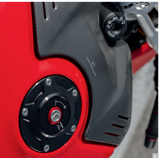
4 Cover depósito de carbono. Boudhon durréservoir en aluminium usiné dans la masse
